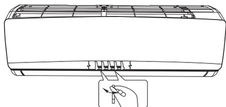
Durante o ajuste deve-se prestar atenção para não pôr os dedos no ventilador, nem no defletor de direção horizontal, cuidando para não danificar os defletores verticais.
