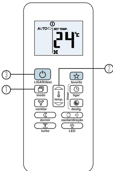
Quando a unidade for configurada no modo AUTO, os modos REFRIGERAÇÃO (COOL), AQUECIMENTO (HEAT - versões quente/frio) ou VENTILAÇÃO (FAN), são selecionados automaticamente conforme a diferença de temperatura entre o ambiente e aquela configurada com o controle remoto.
