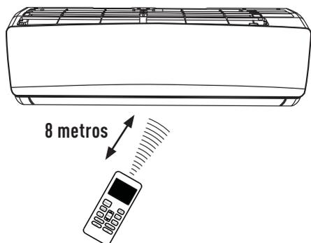
Posicionar o controle remoto de modo que os sinais enviados possam alcançar facilmente o receptor da unidade interna (a uma distância máxima de 8 m).
